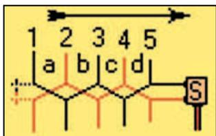
Le dipôle le plus long correspond à une fréquence inférieure ou égale à la fréquence la plus basse désirée et le dipôle le plus court à une fréquence supérieure ou égale à la fréquence la plus haute souhaitée.
